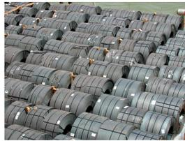
Figura 8: Bobinas Crudas.
