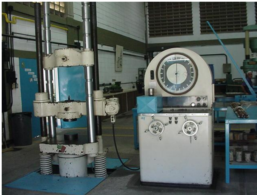
FIGURA 1. MÁQUINA BALDWIN TATE EMERY DE 100 TONELADAS
