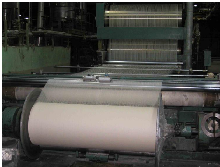
Salida de un plegador engomado al Telar.
