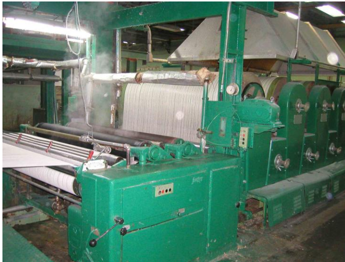
Aplicación de encolantes y producción de plegadores.
