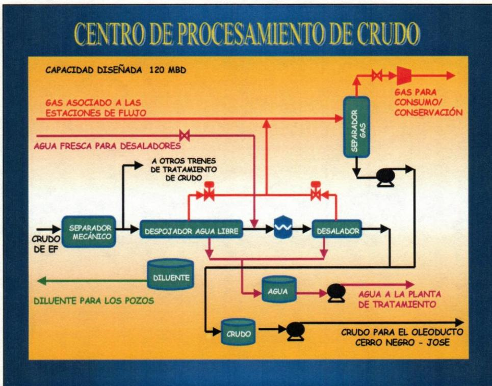
Figura N°2: Diagrama de Flujo del CPF
