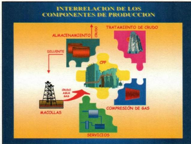
Figura N° 1: Interrelación de los Componentes de Producción
